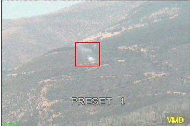
Şekil-3: Kuleye 8,5 km mesafede çıkan bir duman. Yöntem tarafından 10 saniye içinde başarıyla tespit edilmiştir.
