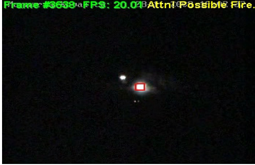
Şekil-3: Tespit edilen gece ateşi ve itfaiye aracına ait dönen tepe lambaları.
